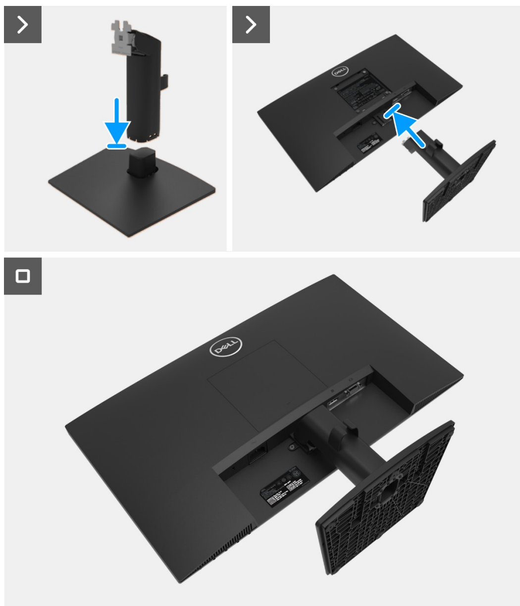
Rysunek 9. Instalacja podstawy
