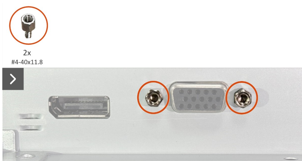
Rysunek 19. Wyjmowanie płytki interfejsu
