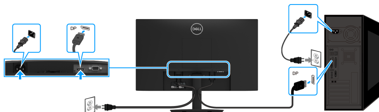
Rysunek 7. Podłączanie kabla DP
