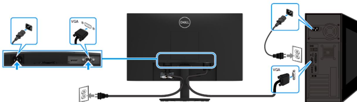
Rysunek 6. Podłączanie kabla VGA
