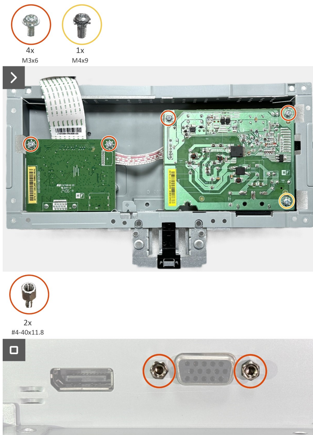
Rysunek 23. Instalacja płytki interfejsu
