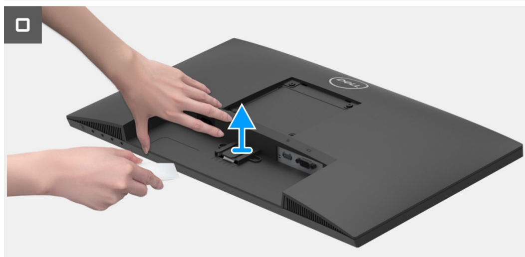
Rysunek 12. Zdejmowanie tylnej pokrywy
