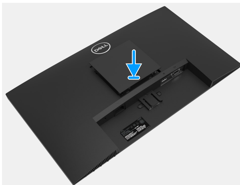
Rysunek 11. Instalacja pokrywy VESA
